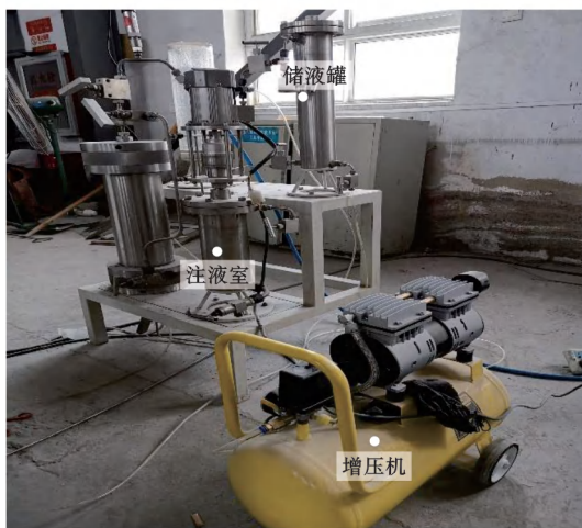
(b) 压裂液注入系统
