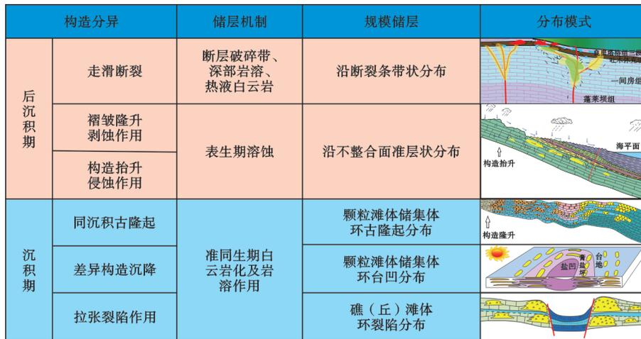
图3 克拉通构造分异对海相碳酸盐岩储层形成与分布的控制作用示意
